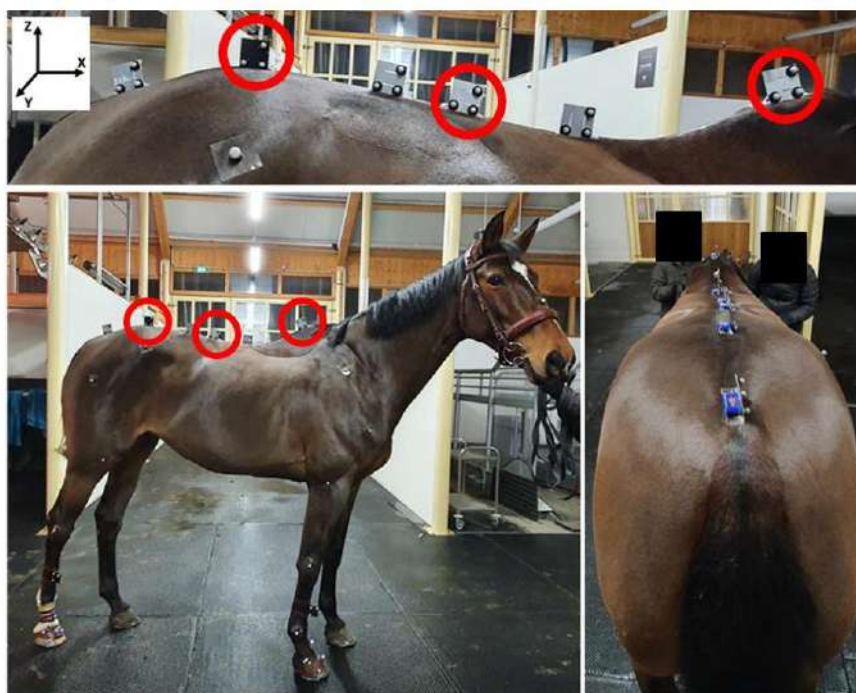
Figure 6 : Positionnement des marqueurs MOCAP et des IMUs sur le cheval (d'après Hatrisse et al. , 2023)
